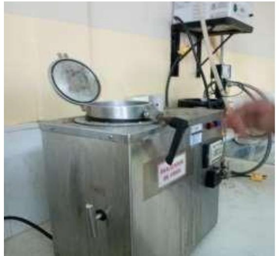
**Fotografía 7:** Enjuague de muestras con agua en temperatura de 80 °C
