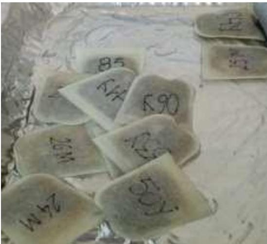
**Fotografía 7:** Muestras sumergidas en acetona
