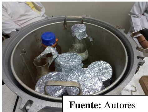
Placas más la solución de Agar en el autoclave
