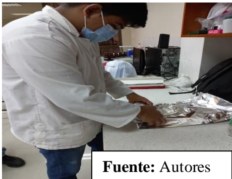
Se envuelven el papel aluminio para lleva al autoclave a esterilizar
