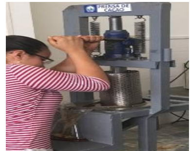
Extracción de grasa
