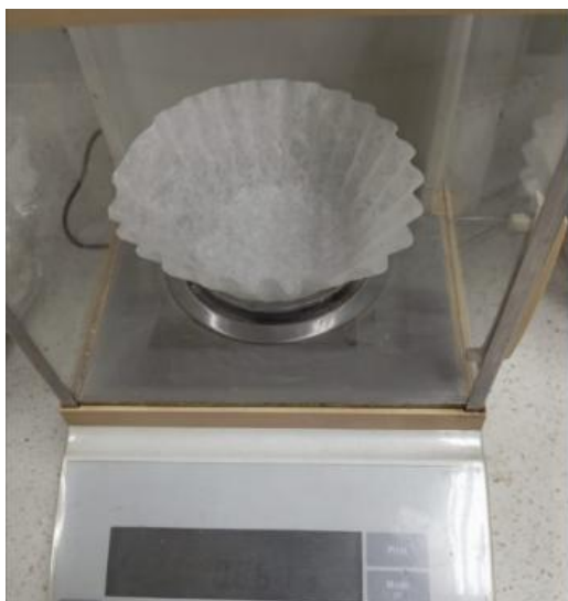
Figura 28. Peso del filtro seco
