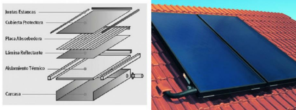
Figura 6. Panel Solar Térmico
