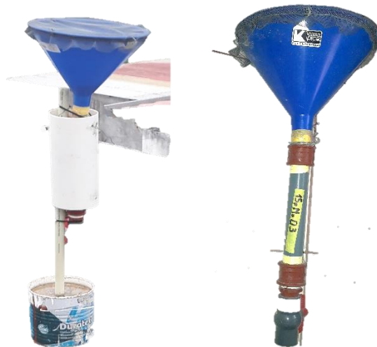
Gráfico 3. Estructura completa del muestreador pasivo.
