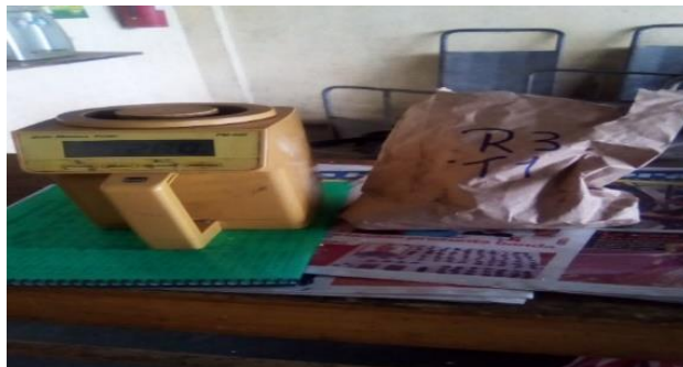
Anexo 22 Aparato utilizado para poder tomar la humedad
