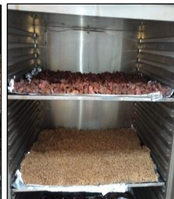
Secado: corteza de cacao (60°C x 48h) Cascarilla de arroz (60°C x 24h)
