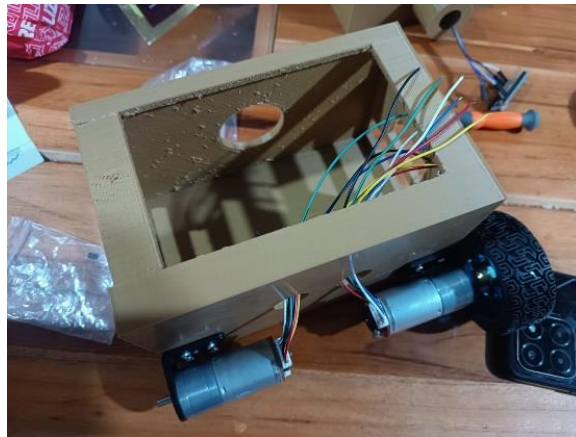
Figura 13 Instalación de motores al cuerpo del robot
