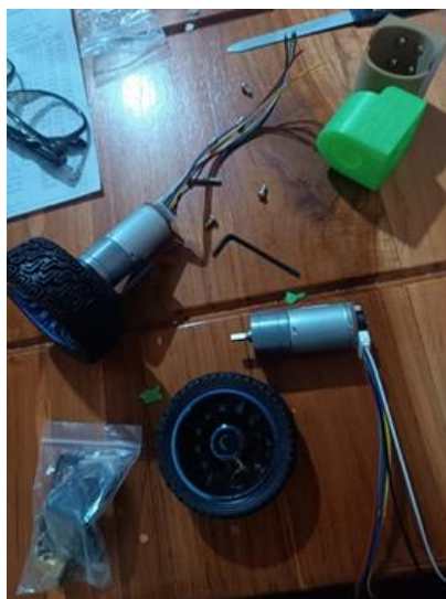
Figura 12 Motores y llantas con sus respectivos tornillos
