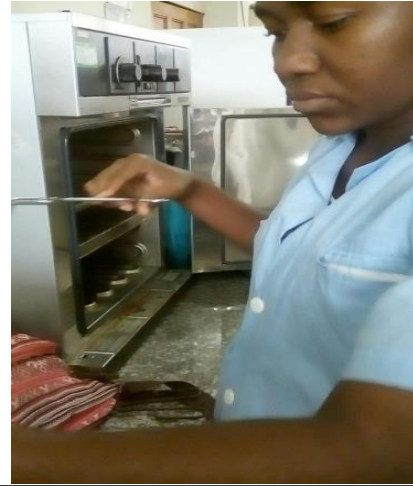
Muestras retiradas de la estufa pasa ser colocadas en el desecador
