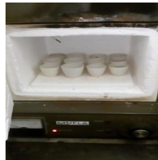
Calcinación en la mufla a 600°C por 3 horas
