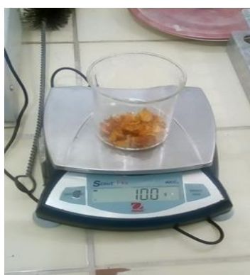
Peso de la muestra para determinación de pH
