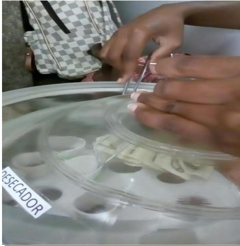
Muestras retiradas de la estufa pasa ser colocadas en el desecador
