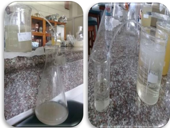
Fotografía 13: Filtrado de la pectina luego de la precipitación
