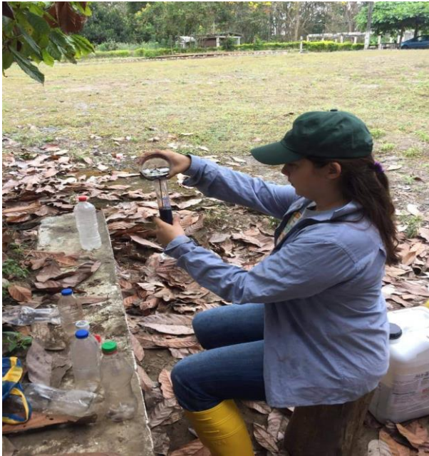
a. Medición de 200 L de cada producto. Utilizando una probeta.
