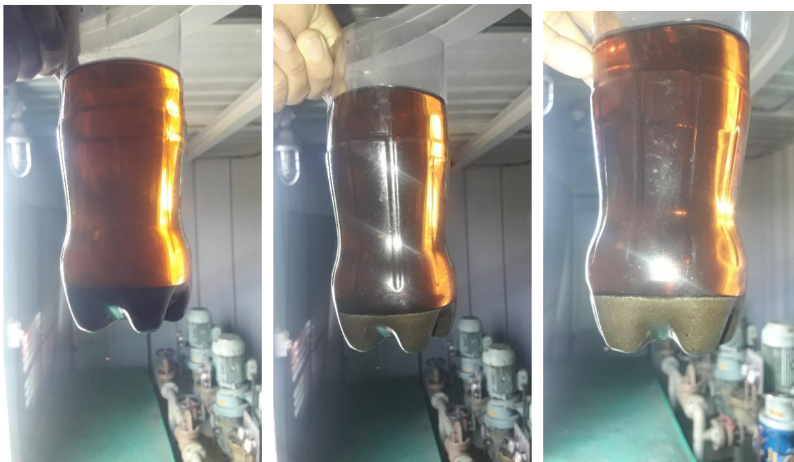
Anexo 6. Combustible dentro del tanque de purificación.
