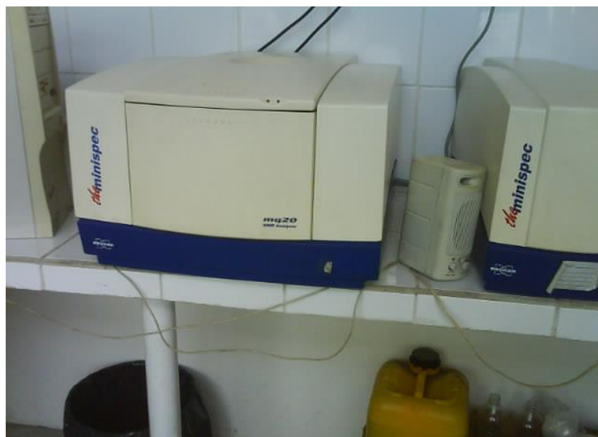
Figura 11. Equipo utilizado para determinar sólidos (Minispec)
