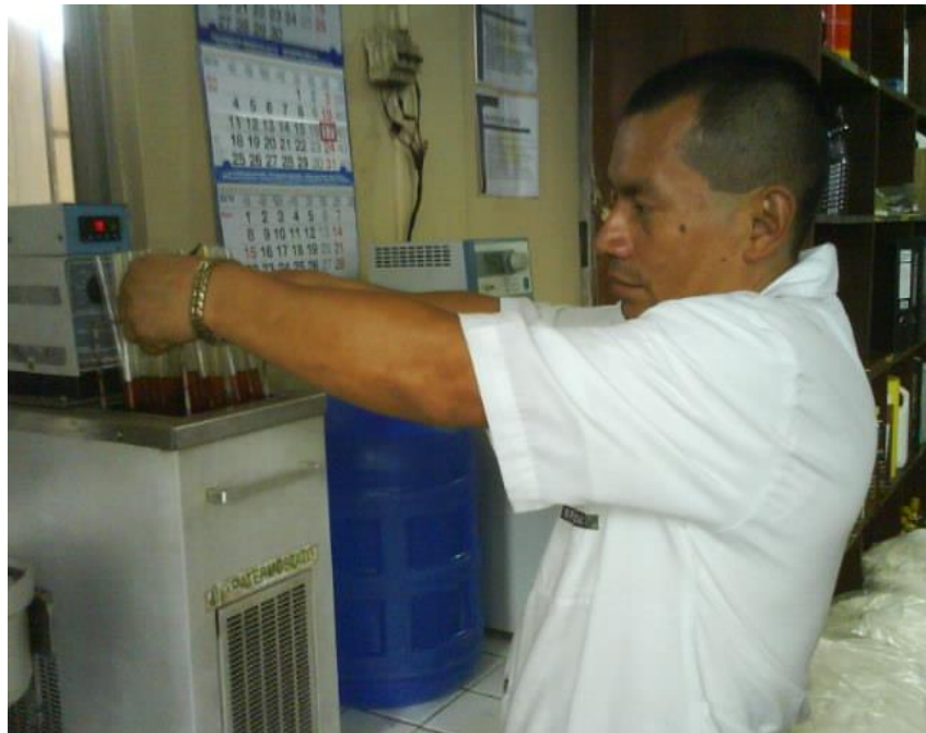
Figura 10. Colocación de las muestras en el ultratermostato a temperaturas establecidas
