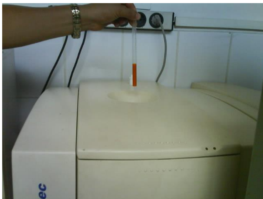
Figura 12. Colocación de la muestra en la ranura del Minispec
