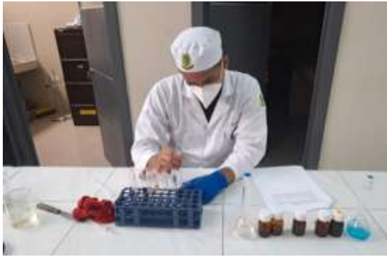
Adición del reactivo de Fehling a los tubos de ensayo con la muestra
