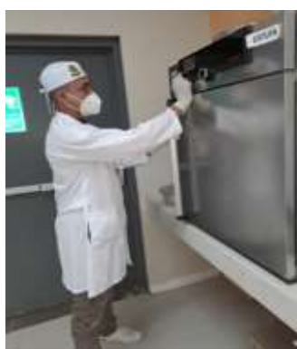
Calibrado de temperatura y tiempo para secado de la placenta en la estufa
