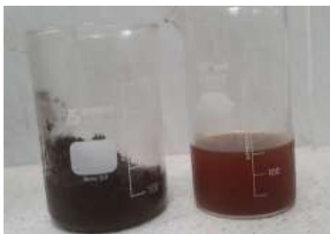
Separación solida – liquido de la solución agitada
