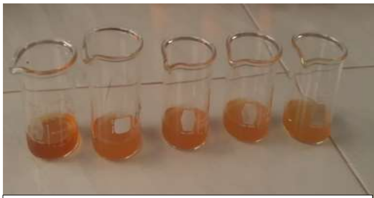
Dilución 1:75 de los extractos de la placenta de cacao obtenidos para el análisis del espectro de absorbancia
