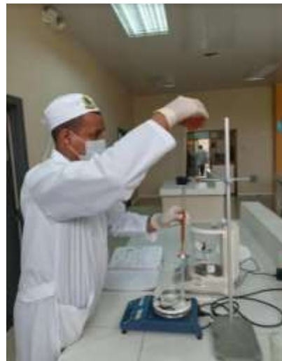
Adición del extracto con alginato de sodio a la bureta graduada para técnica de goteo
