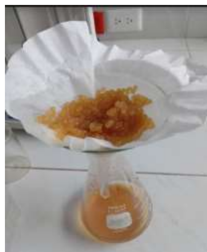
Filtrado de las capsulas para la separación de estas con la solución de cloruro de calcio.
