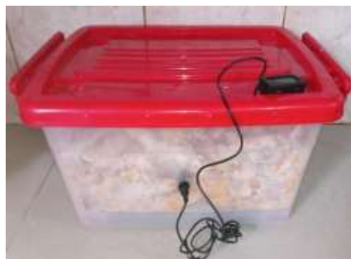
Fermentador artesanal con sensores de temperatura v humedad.
