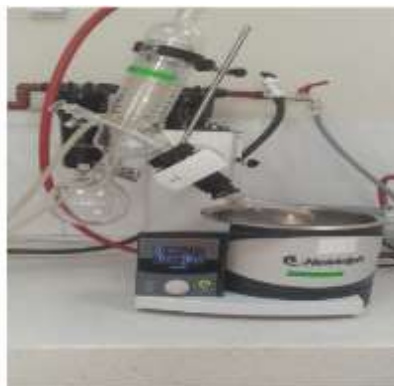
Rotavapor ocupado para la extracción del concentrado
