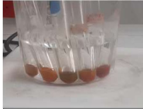
Inmersión de los tubos de ensayo con la muestra y el reactivo de Fehling en baño maría
