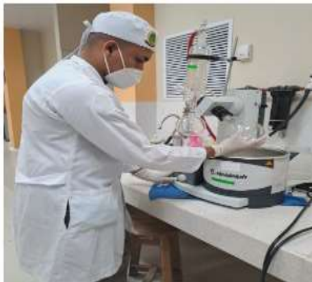
Calibrado del Rotavapor para extracción hidroalcohólica
