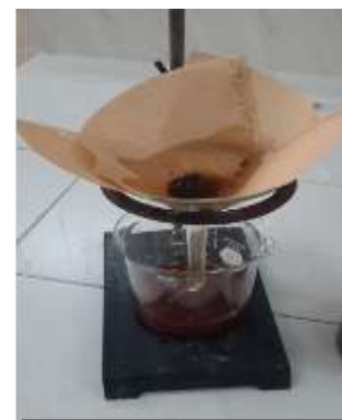
Filtrado de solución mediante papel filtro de 15 micrómetros
