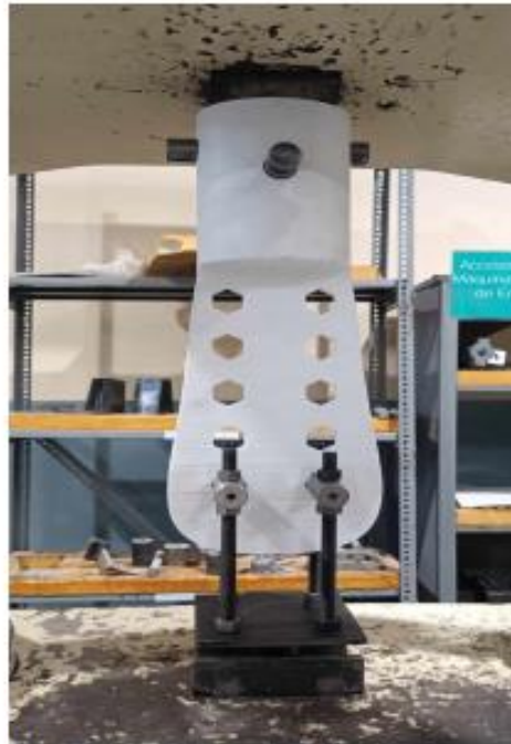
Fotografía 3. Montaje de la muestra M23.099.02 para ensayo de carga.
