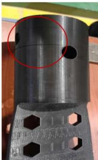
Fotografía 2. Muestra M23.099.01 después del ensayo de carga.
