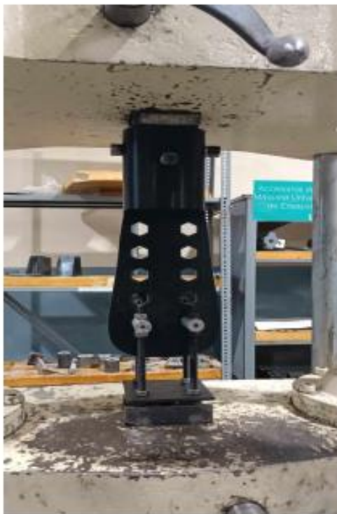
Fotografía 1. Montaje de la muestra M23.099.01 para ensayo de carga.
