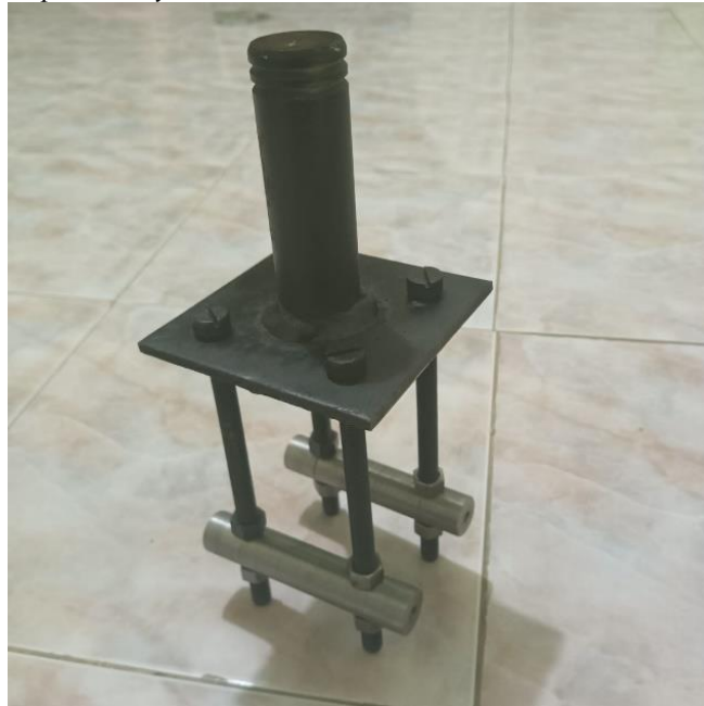
Figura 67. Adaptación inferior para ensayo de tracción.
