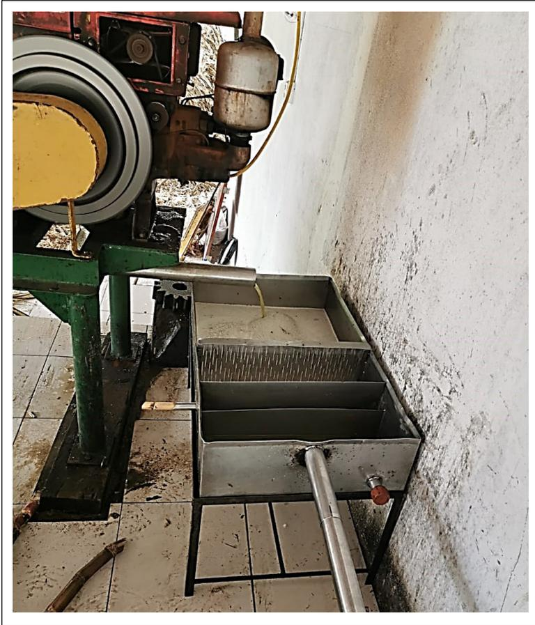
Figura 9. Filtración y decantación del jugo.
