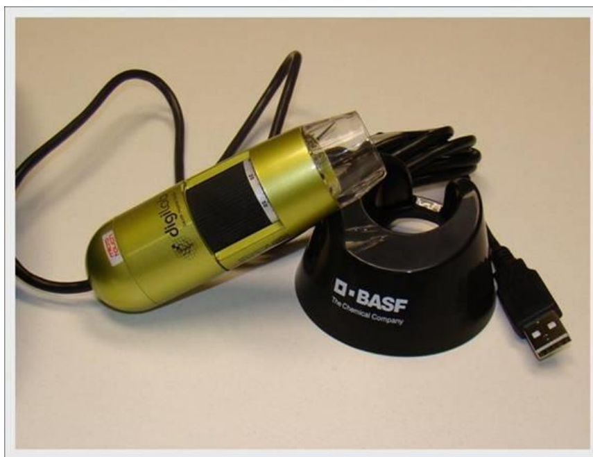
Figura 1. Digilab (Lupa digital capaz de aumentar una imagen hasta 200 veces) instrumento usado en las investigaciones fitosanitarias.
