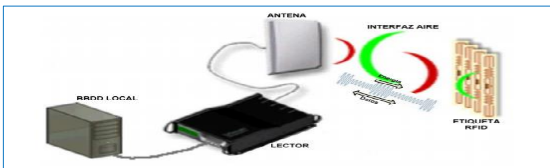
Figura # 15: Diagrama de Funcionamiento de un Sistema RFID.
