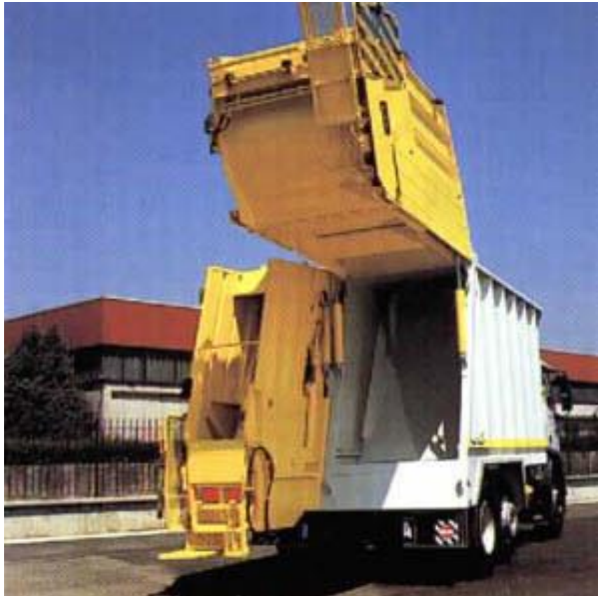
Figura N° 21. Vehículo recolector compactador de doble cámara, para la recolección selectivas, vista de la parte trasera del vehículo, donde se aprecia el sistemas de las dos cámaras.
