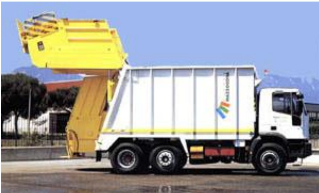
Figura N° 20. Vehículo recolector compactador de doble cámara, para la recolección selectivas, visto de costado.
