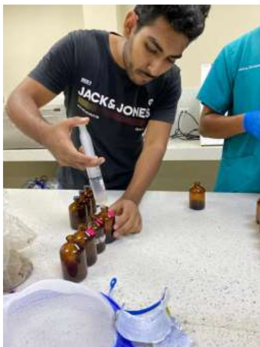
Figura 7. Colocación de inóculo ruminal: saliva artificial (relación 30:70)
