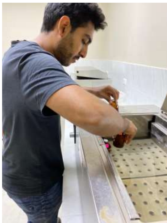
Figura 9. Colocación de botellas ámbar con inóculo ruminal: saliva artificial (relación 30:70) en baño maría.
