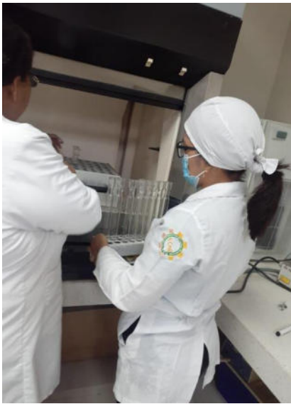
Anexo 47. Ubicación de los tubos en el digestor.
