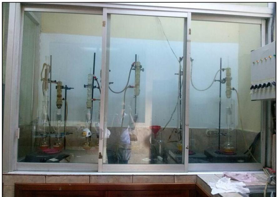
**Figura 5.- Equipo de Soxhlet**
