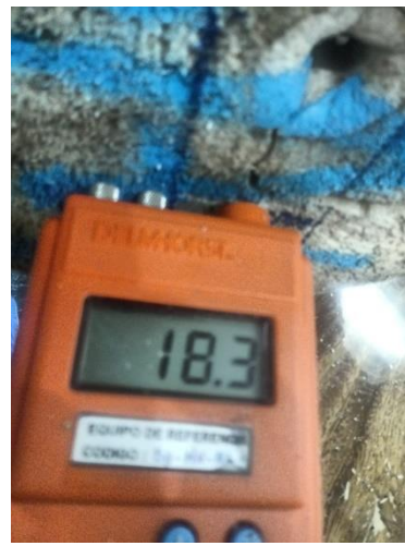
Foto 4: Medición del porcentaje de humedad en disco maquinaria.
