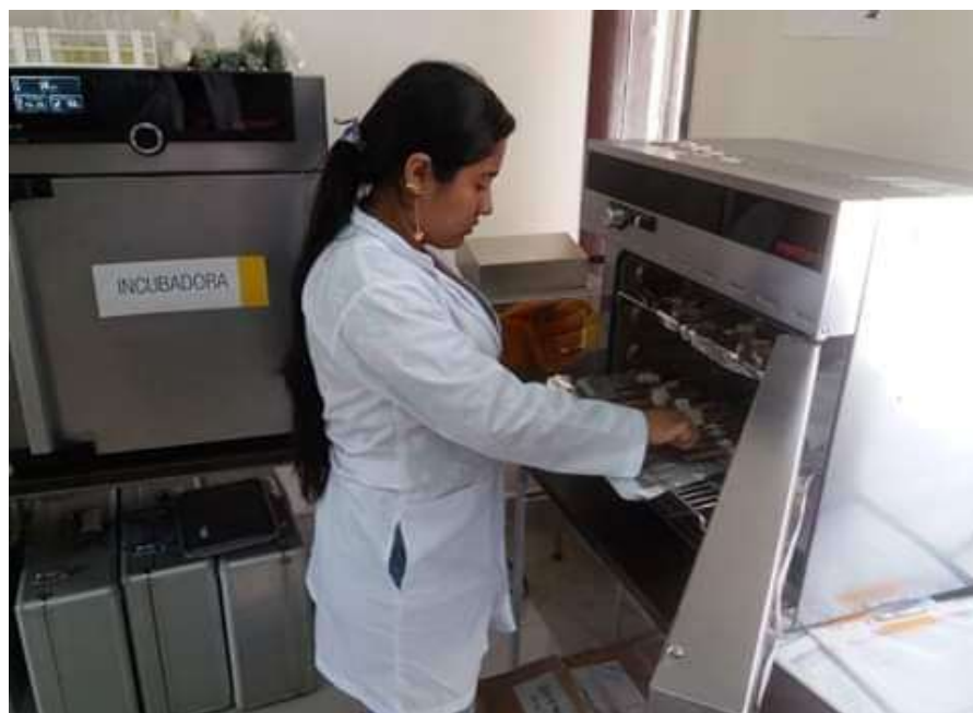
Anexo 11: ubicación de muestras en la estufa (por 24 h. a 105 °c)
