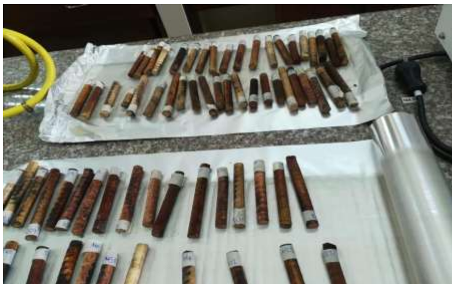
Anexo 10: Muestras preparadas (pesadas) en laboratorio
