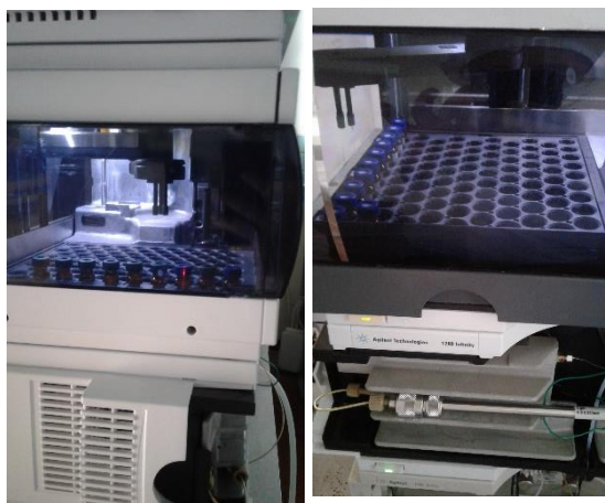
Inyección de la muestra en el cromatógrafo.
