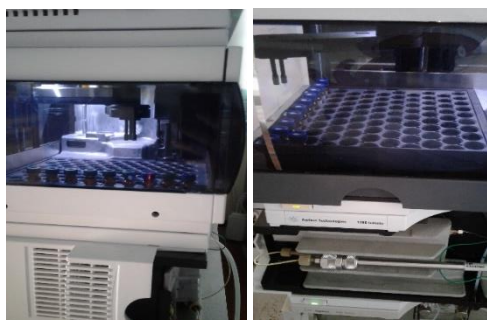
Inyección de la muestra en el cromatógrafo
