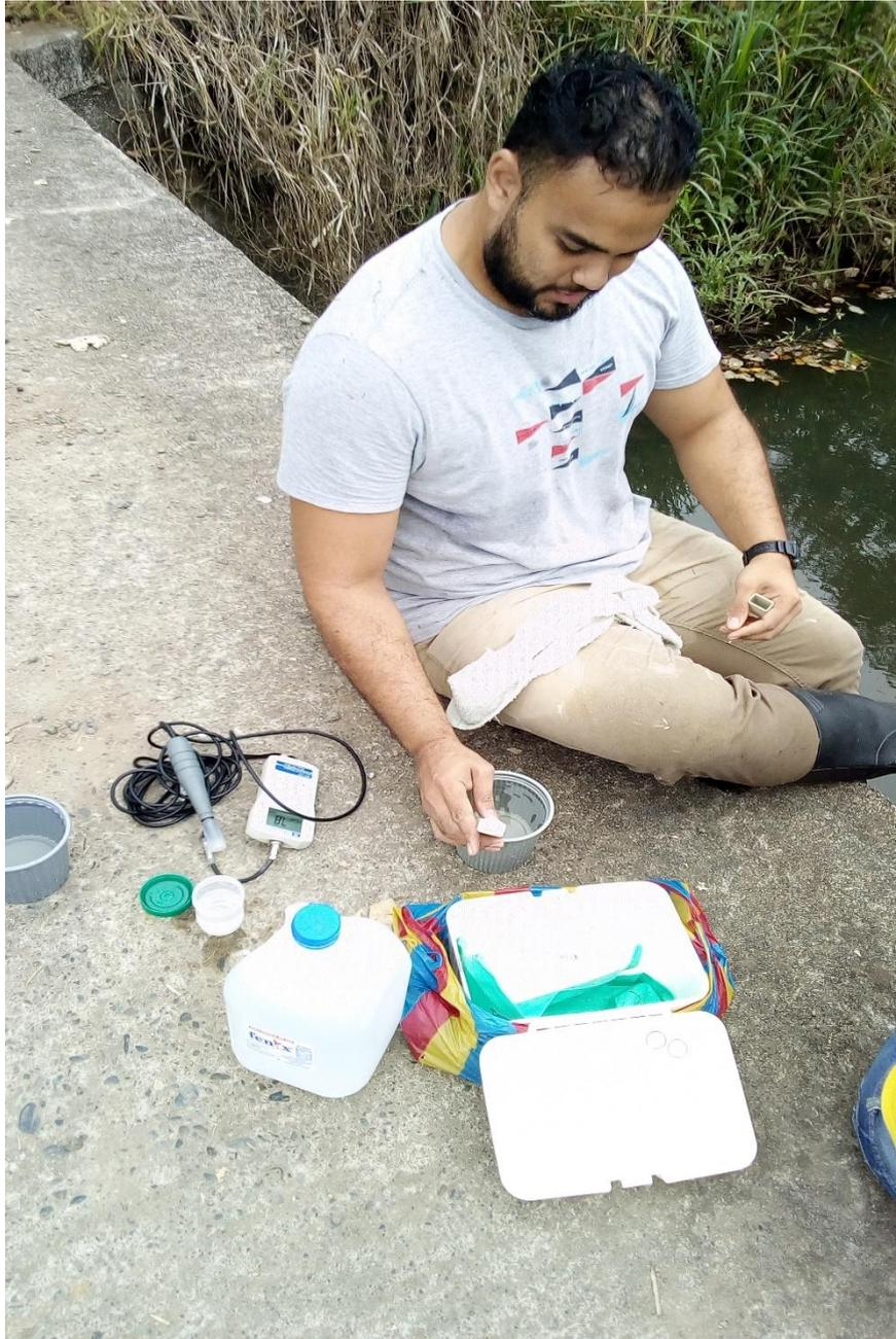
Fotografía 2. Medición de los parámetros de pH, temperatura y conductividad eléctrica
