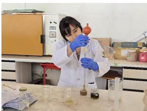
Figura 13 Medición de saponina de quinua
