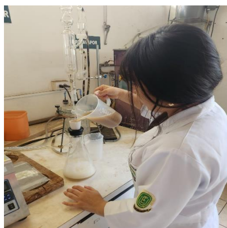
Figura 5 Filtración de la saponina de quinua
