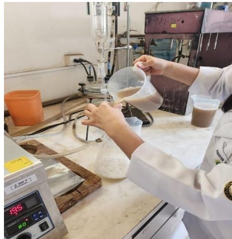
Figura 4 Colocación de la saponina en el filtro
