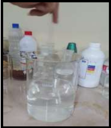
Preparación de la solución de policloruro de aluminio en 1 lt de agua destilada (concentración madre del 5%)
