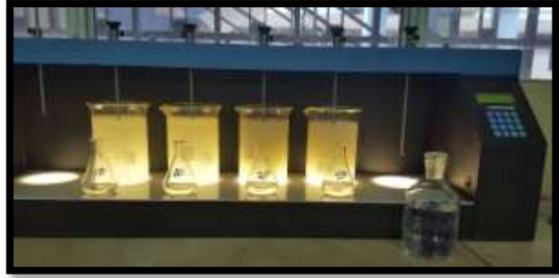
Homogeneización (cada vaso contiene 1lt de agua residual)
