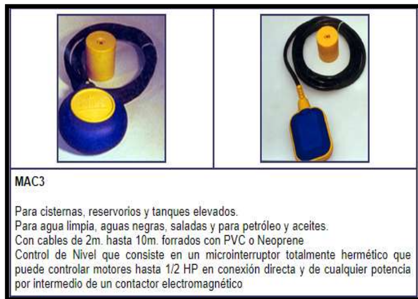
Gráfico 49. Interruptor automático de nivel actuado por flotador.
