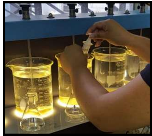
Agregación de la poliacrilamida aniónica (floculante)
