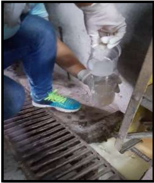
Toma de muestra del efluente proveniente del área de corrugación.
