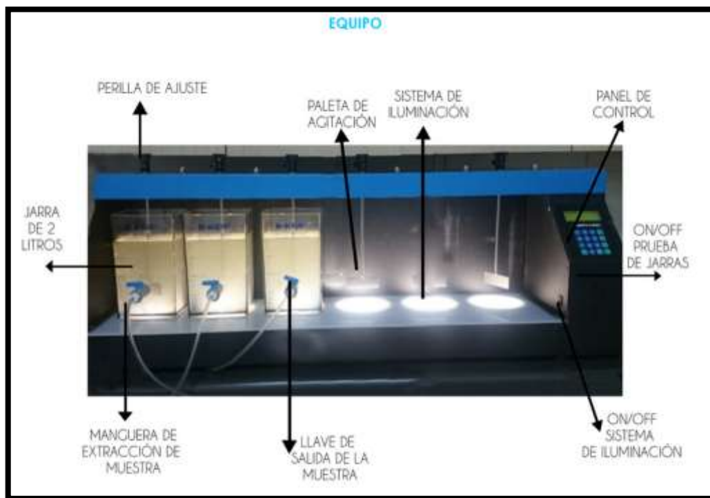
Gráfico 8. Equipo para realizar las pruebas de jarras (tratamiento físico-químico).
