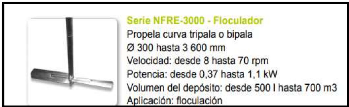
Gráfico 44. Especificaciones técnicas del floculador en función de las rpm requeridas.
