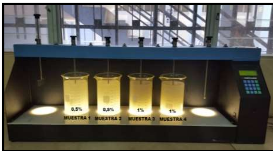
Gráfico 36. Test de jarras con diferentes concentraciones madre de PAC.
