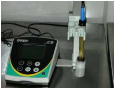
**ANEXO 13: EQUIPO UTILIZADO PARA DETERMINACIÓN DE pH**
