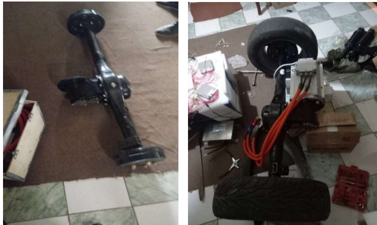
Figura 58. Instalación del motor eléctrico en el diferencial.
