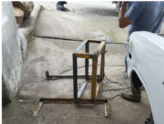
Figura 56. Construcción de bases para el banco de batería.
