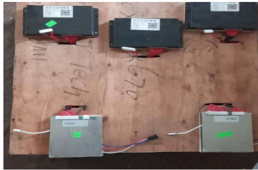
Figura 55. Comprobación del funcionamiento del BMS.
