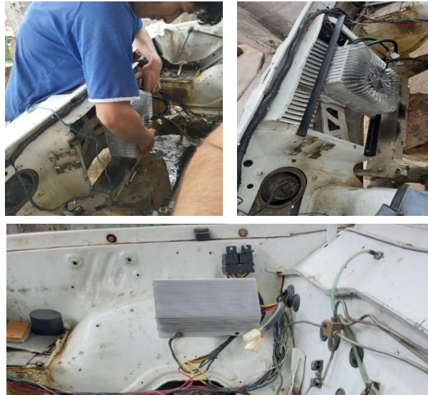
Figura 59. Instalación del cargador y convertidor.
