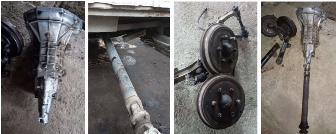
Figura 43. Desinstalación de componentes de transmisión y tambores delanteros.
