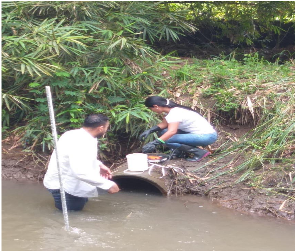
Fotografía 3. Toma de muestra de la descarga principal del tramo 1
