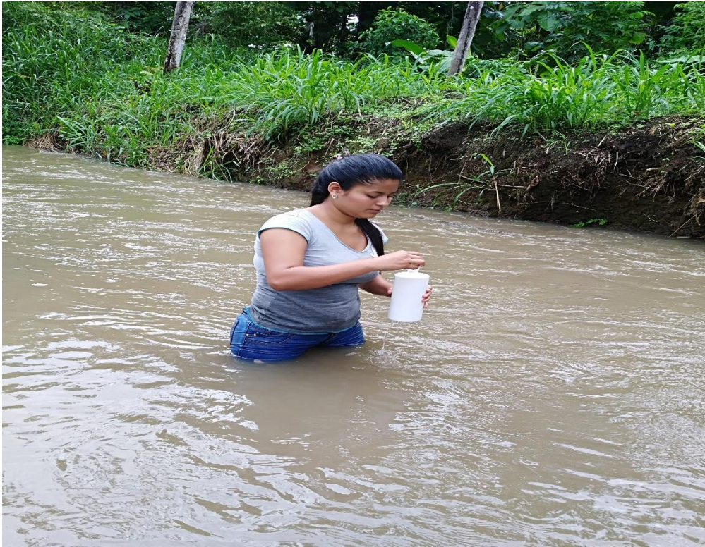
Fotografía 2. Toma de muestra para análisis de DBO, aguas arriba
