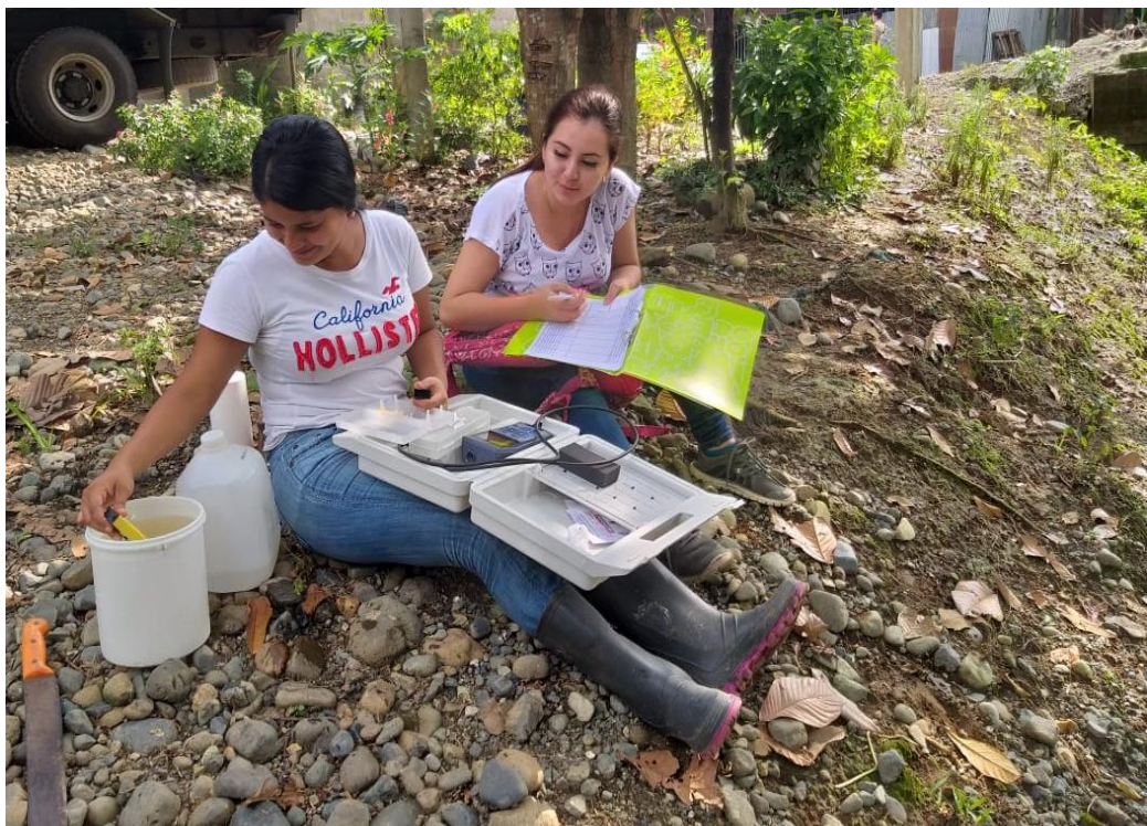
Fotografía 4. Mediciones del oxígeno disuelto en el punto de muestreo tramo 1
