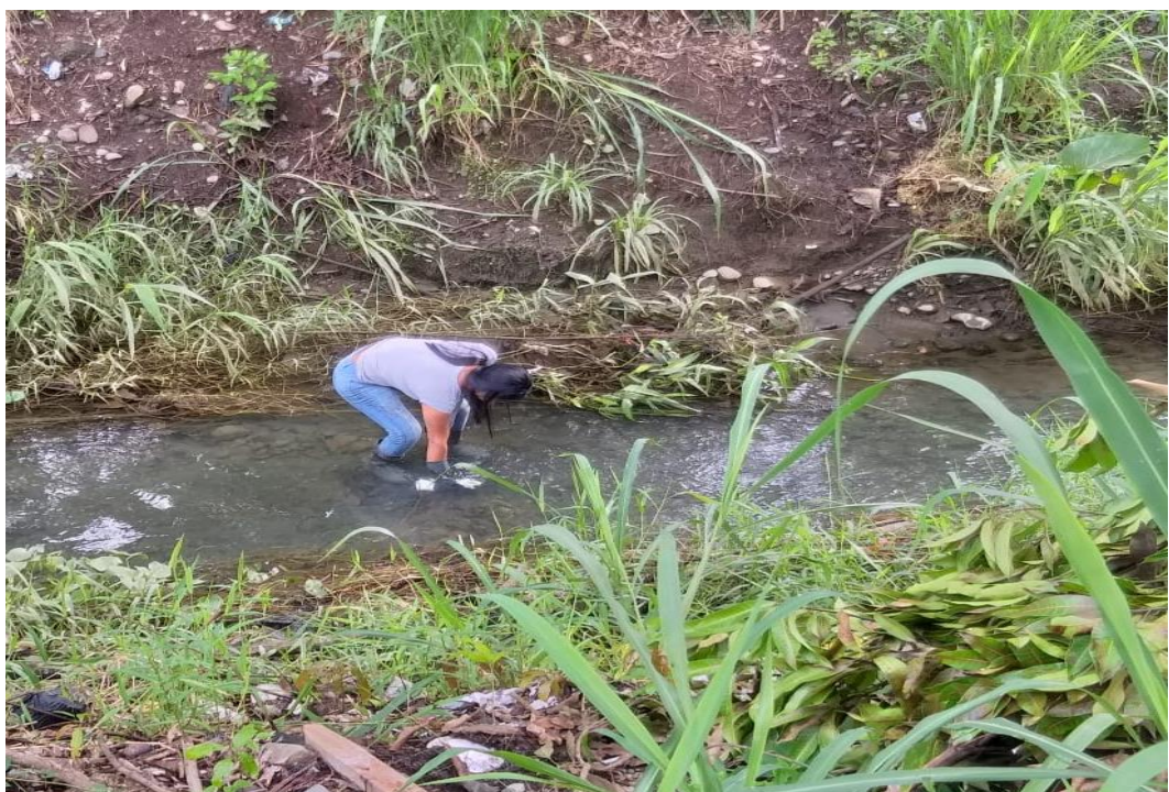
Fotografía 5. Toma de muestra de agua para el análisis de la DBO en el tributario 1
