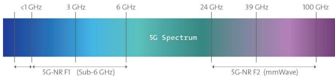
Figura 2 Espectro 5G-NR: rangos de frecuencia FR1 (sub-6 GHz) y FR2 (mmWave).
