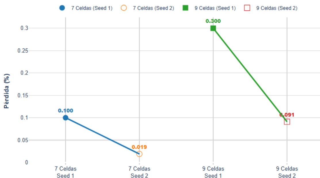
Figura 25 Relación de la pérdida de paquetes en UMa con 7 celdas y en RMa con 9 celdas
