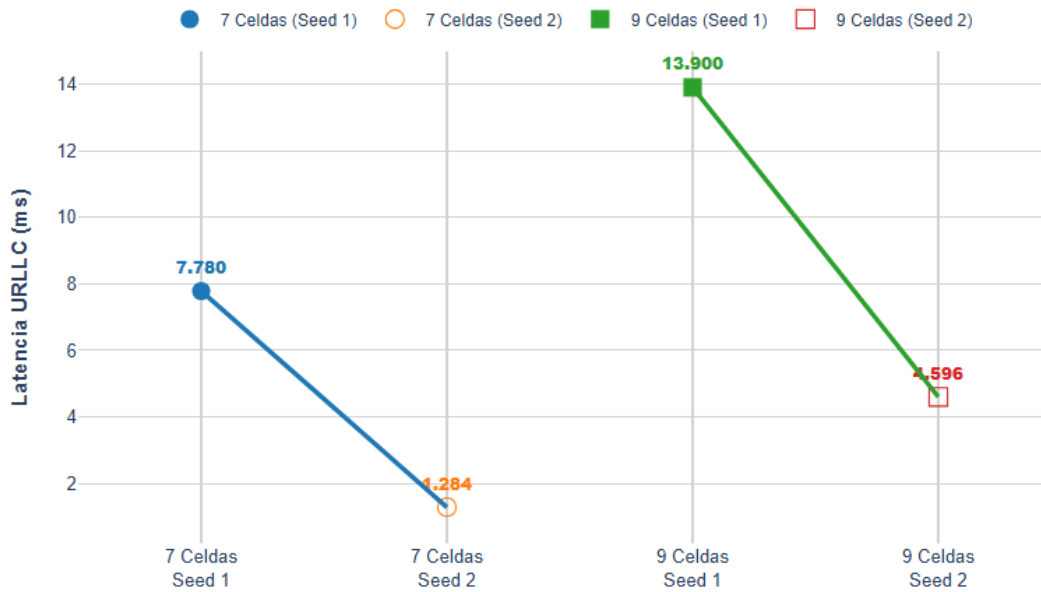
Figura 22 Relación de la latencia URLLC en UMa con 7 celdas y en RMa con 9 celdas
