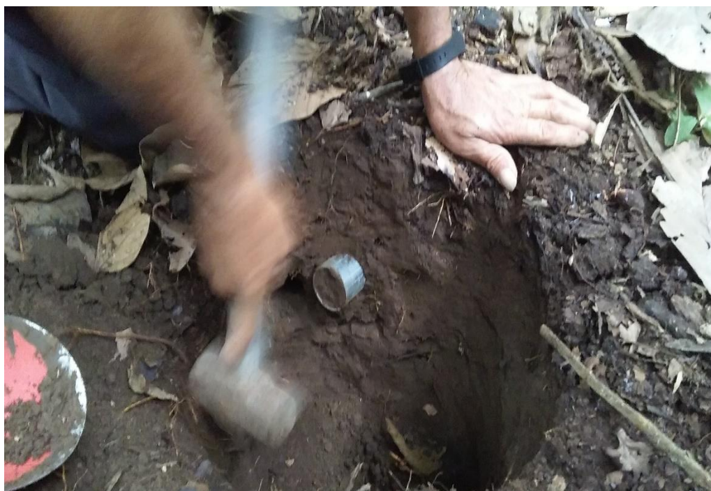
Foto 4 Toma de muestra para análisis físico del suelo
