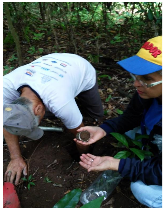
Foto 3 Toma de muestra en los cilindros
