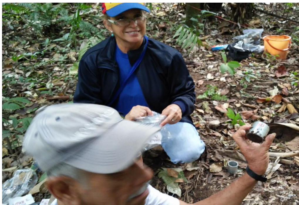
Foto 5 Toma de muestra para análisis físico del suelo
