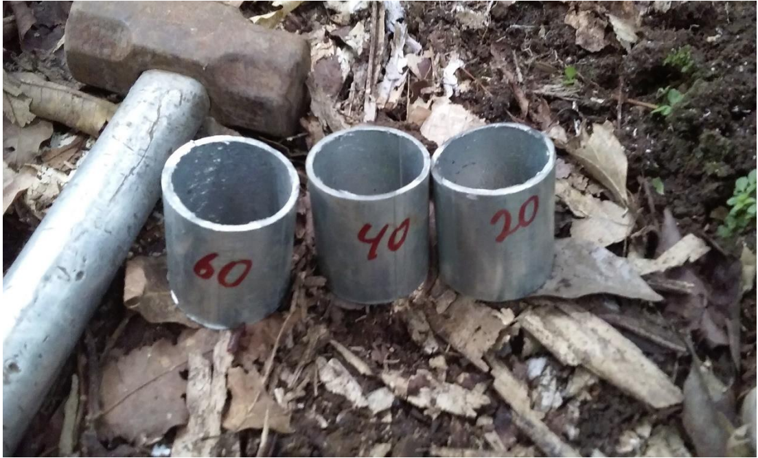
Foto 1 Cilindros para la toma de muestra del suelo
