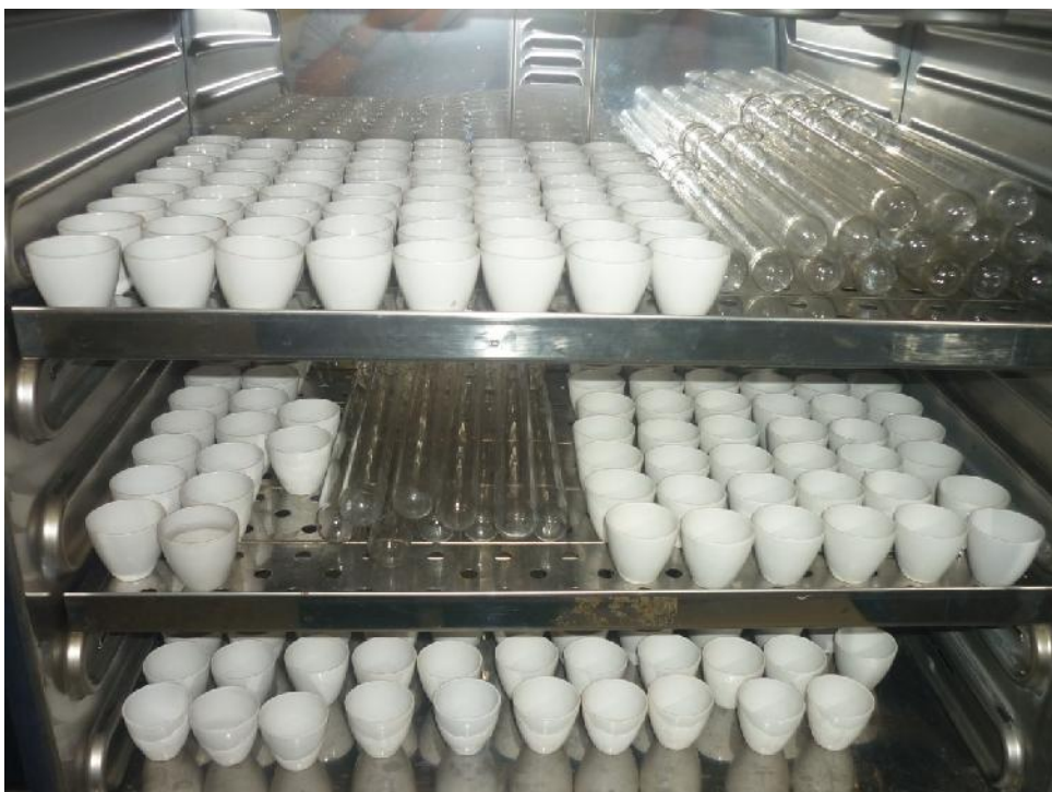
Anexo 32. Crisoles de porcelana para realizar análisis de materia seca, materia orgánica.
