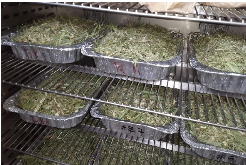
Anexo 15. Pastos secando en estufa de aire forzado.
