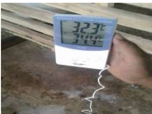
Toma de temperatura en el piso de concreto.
