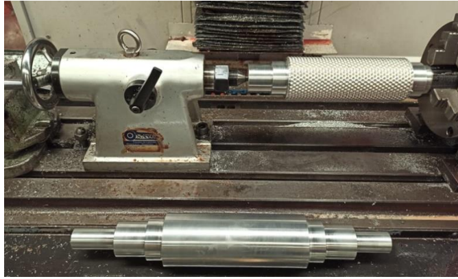
Figura 94. Mecanizado de los rodillos en la fresadora CNC.
