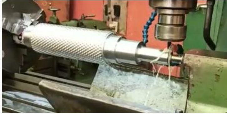
Anexo 48. Mecanizado del cuñero en una fresadora convencional.
