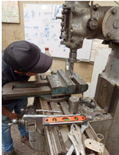
Anexo 46. Mecanizada de la base de los rodillos en una fresadora convencional.
