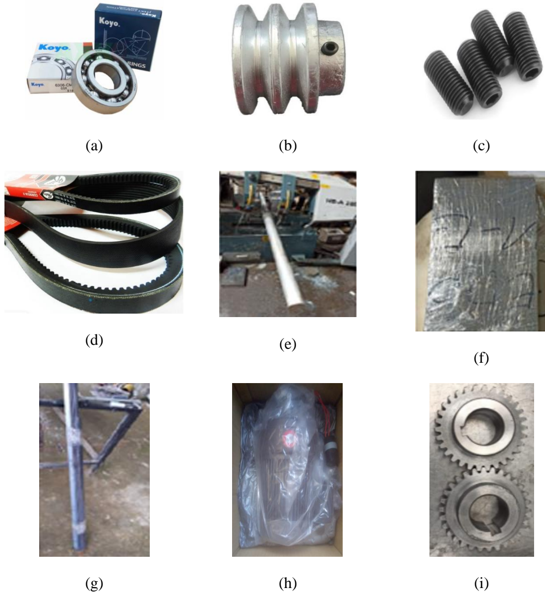
Figura 93. Elementos mecánicos para la construcción de la máquina estampadora de cera de abeja: (a) rodamiento 61810, (b) polea de aluminio de 3 in, (c) prisioneros, (d) banda dentada, (e) eje sólido de aluminio 6061 de 3 in de diámetro, (f) placas de duraluminio, (g) ángulos en L, (h) motorreductor de 10 rpm, (i) engranaje recto de acero AISI 4140.
