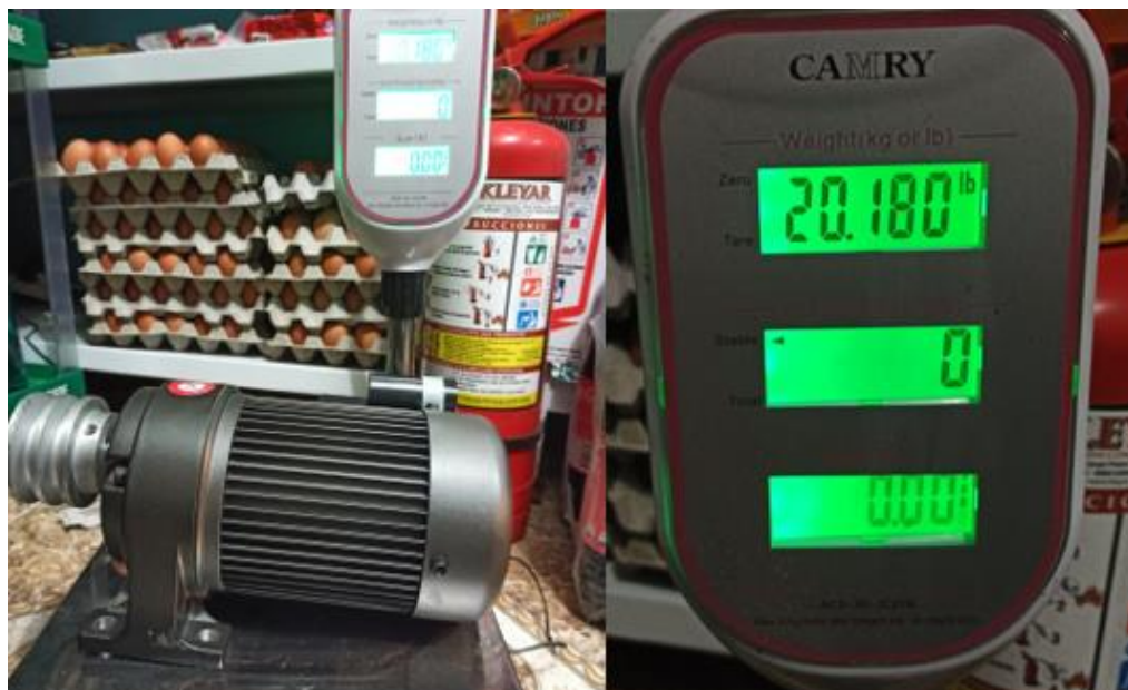
Anexo 43. Masa del motorreductor lineal.
