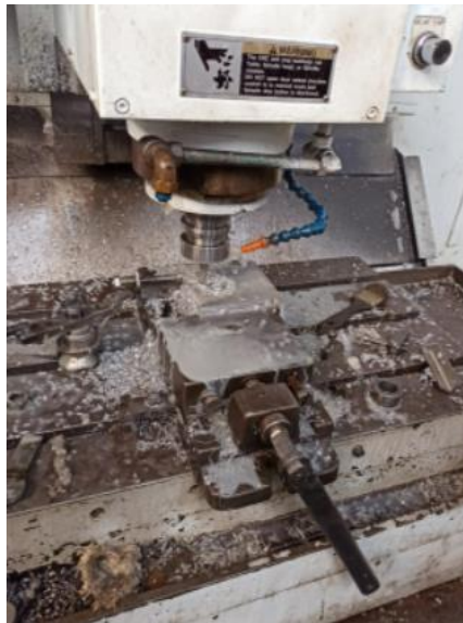
Anexo 49. Mecanizado de la base superior para los rodamientos en una fresadora CNC.
