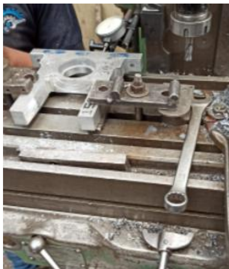
Anexo 50. Mecanizado de la base inferior para las entradas del rodamiento en una fresadora convencional.
