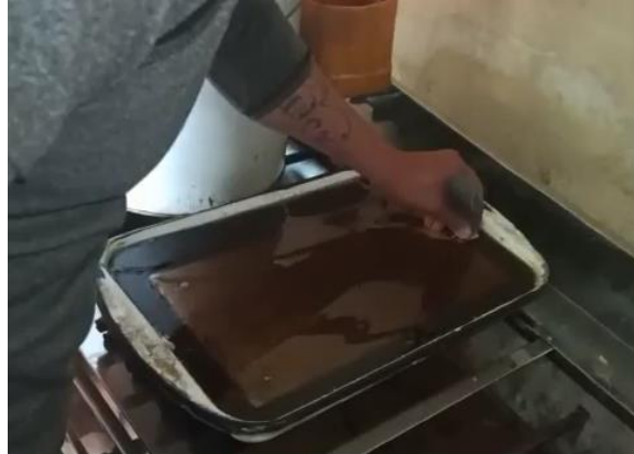
Figura 108. Sumergido de la tabla de madera en la cera líquida.
