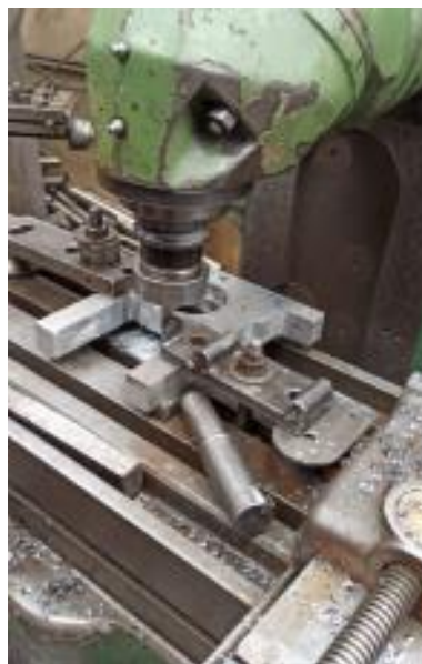
Figura 95. Mecanizado de la base de los rodillos en la fresadora.
