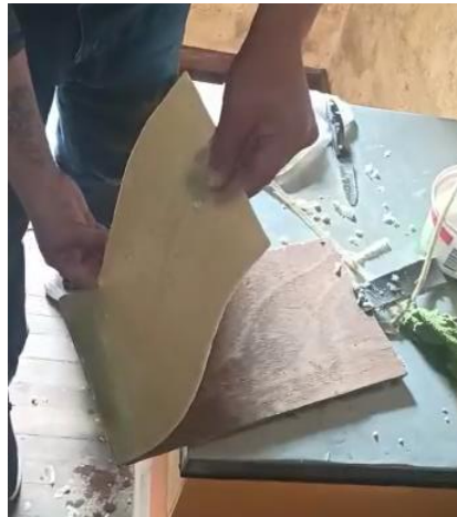
Figura 111. Obtención de la lámina de cera de abeja.
