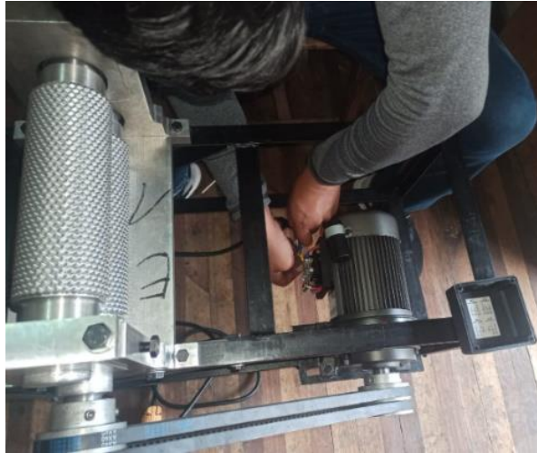
Anexo 54. Conexión del motorreductor con el panel de control.
