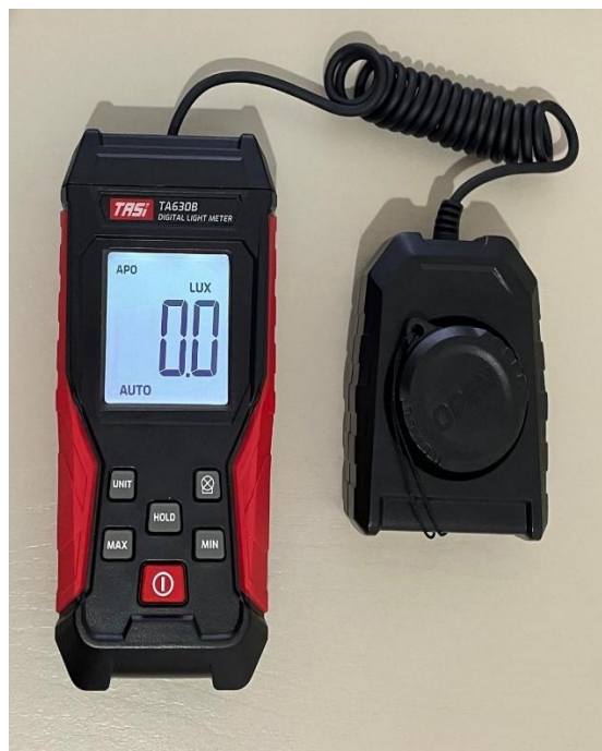
Instrumento de medición (Luxómetro TASI modelo TA630B)
