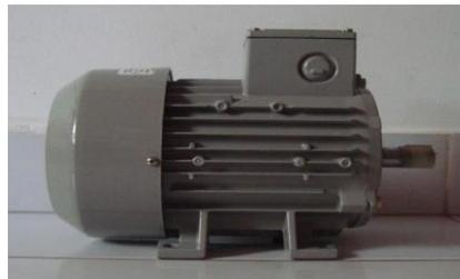
Se empleó un motor marca SIEMENS de 1 Hp de potencia que funciona a 1650 rpm y con una alimentación eléctrica de 220V, 60 Hz, que brindara la fuerza mecánica que hará mover el tornillo sinfín.
