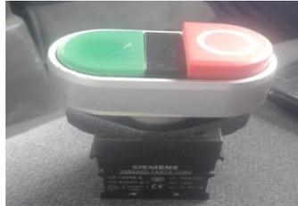
Estos pulsadores colocados en la caja de control son los que permiten, encender el equipo (luz piloto color verde) y apagarlo (luz piloto color rojo).
