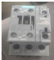
Se utilizó un contacto SIEMENS SIRIUS de 220 V – 50/60 Hz, ya que permite tener un amplio rango de protección en caso de sobrecargas y para la supervisión y control en el arranque del motor.
