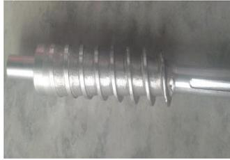
Este eje de 50mm de espesor fue torneado según el diseño planteado, para que además de ejercer una presión hacia adelante del producto a tratar también lo haga hacia los lados, es decir hacia las paredes de la criba que lo rodea, obteniendo un mayor rendimiento en cuanto a extracción.
