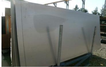
Se utilizó una plancha de acero inoxidable para la construcción de la mesa sobre la cual va el equipo de extracción, también para la fabricación de la tolva de recepción de materia prima y para la tolva de la salida del bagazo.
