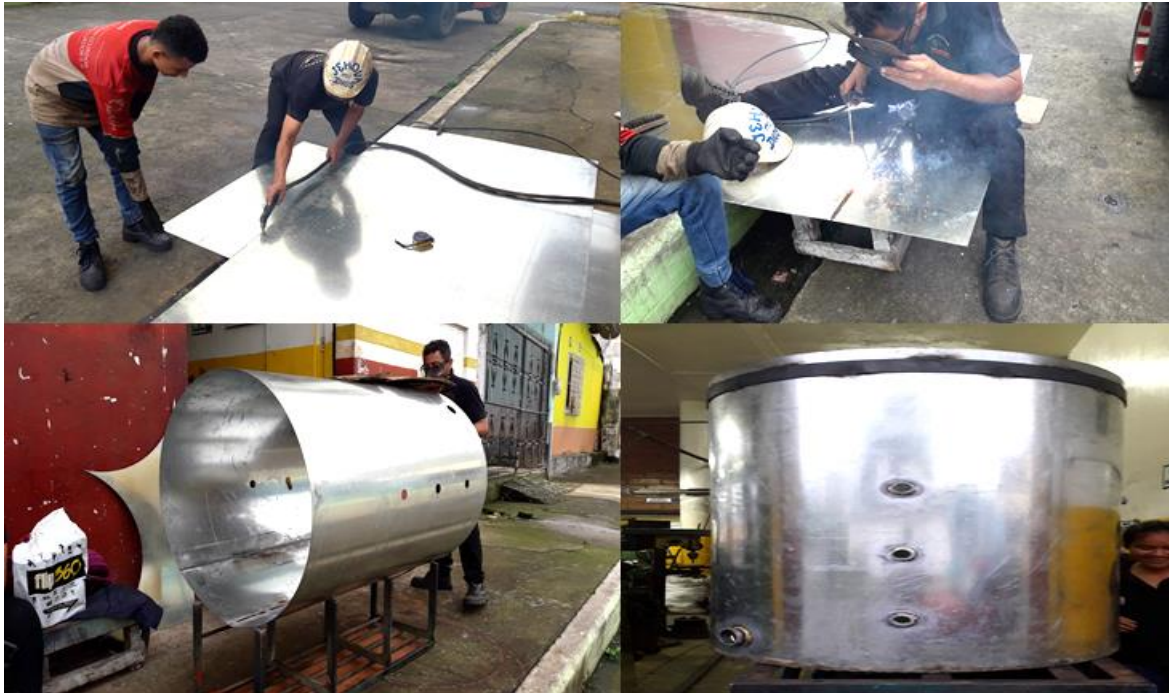
Anexo 10. Construcción de reservorio del calentador eléctrico en Taller Industrial Salazar.
