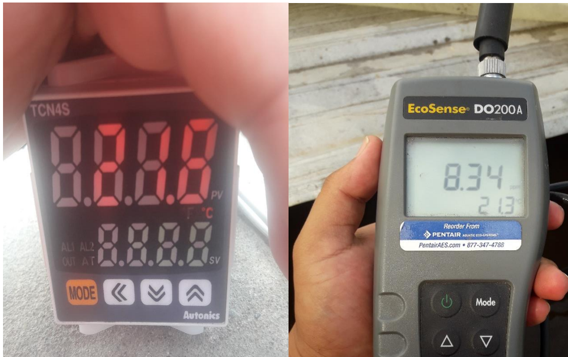
Anexo 7. Sensor EconSense DO200A y Controlador de temperatura TCN4S utilizados para medición de temperatura en el estanque en estudio.
