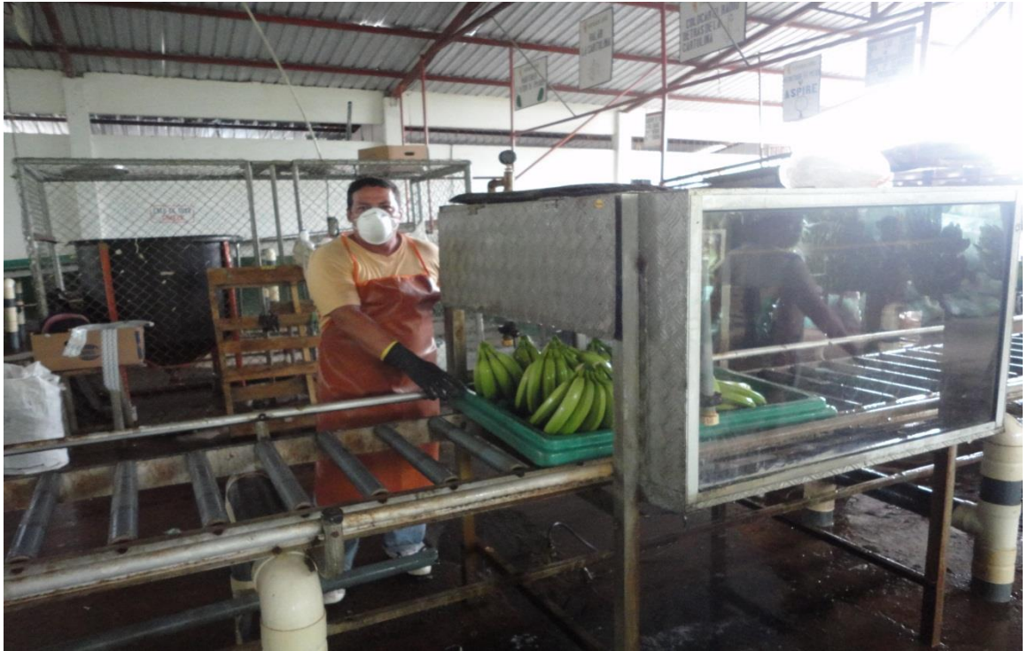
Foto 1. Fumigación por cámara
