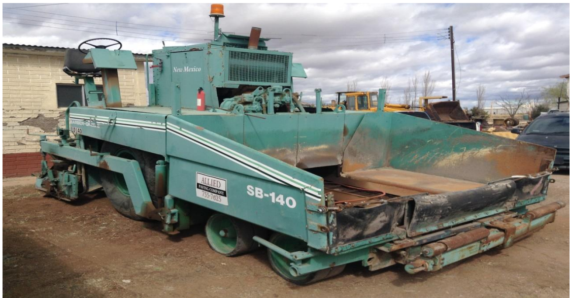
Figura 8. Finisher terminadora de asfalto
