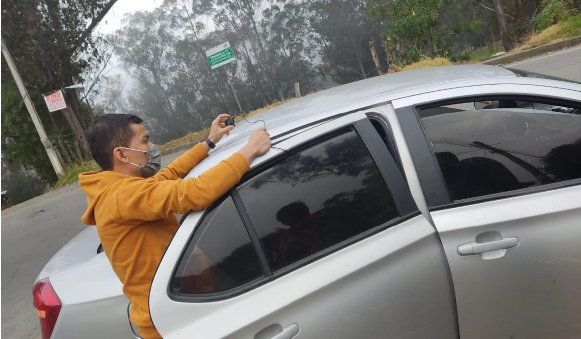
Anexo 7. Instalación del soporte imantado para el medidor OBD II.
