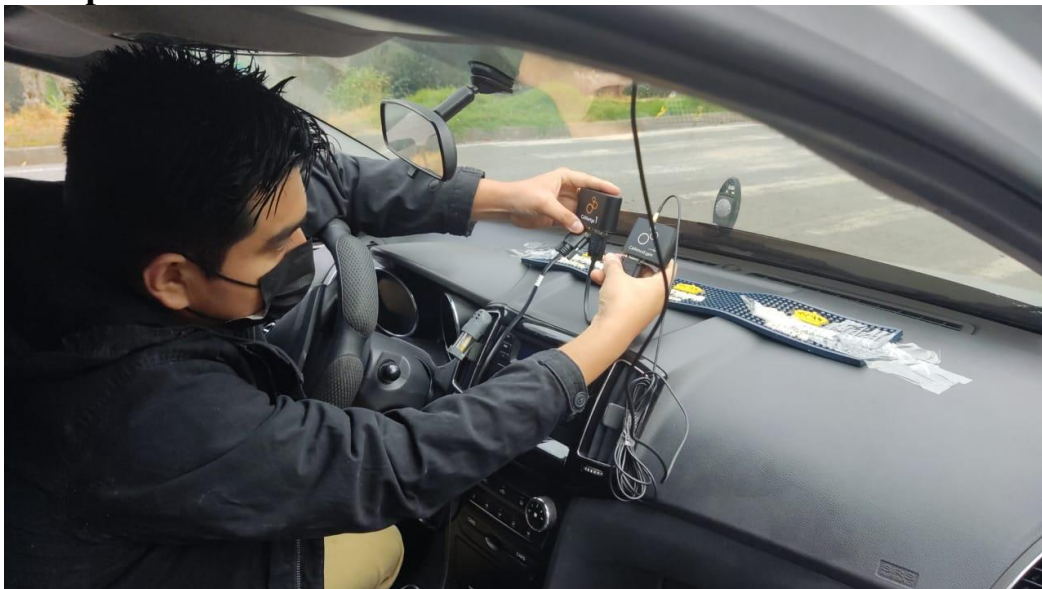
Anexo 6. Conexión del dispositivo Can Edge 1 OBD: 2x registrador de datos de bus can (sd + rtc).
