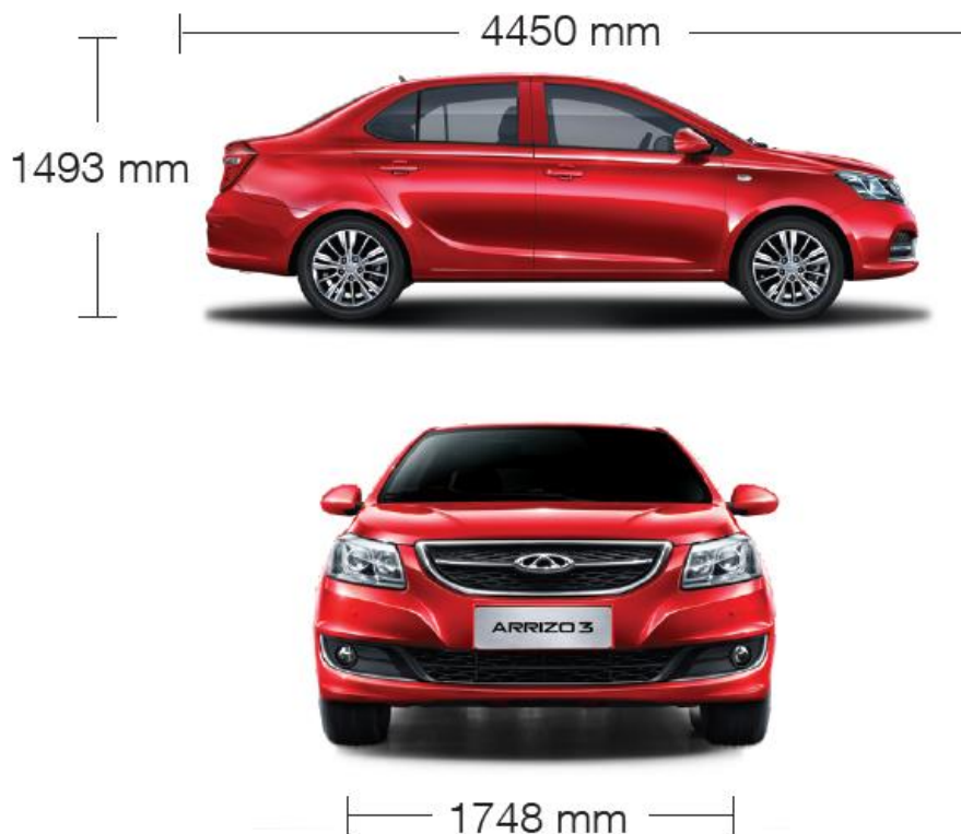
Figura 40. Dimensiones generales del vehículo de estudio, [18].
