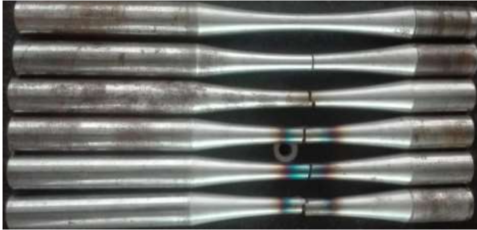
Figura 62. Resultado de las fallas desde altas hasta bajas cargas para los ensayos de probetas.
