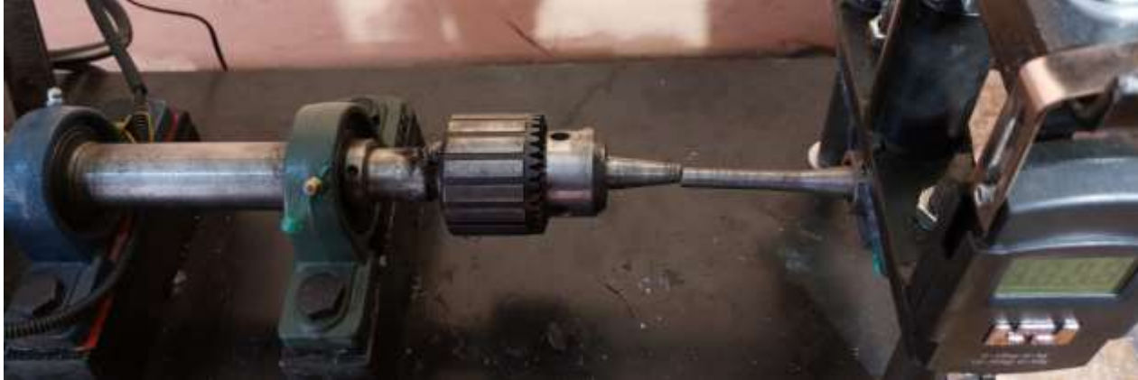
Figura 61. Montaje y fractura de una probeta en la máquina de ensayo de fatiga.
