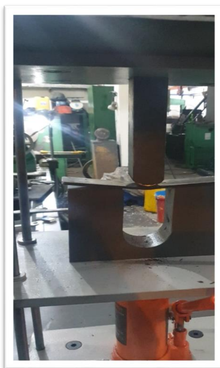
Anexo 13. Doblado de la probeta parte 1.
