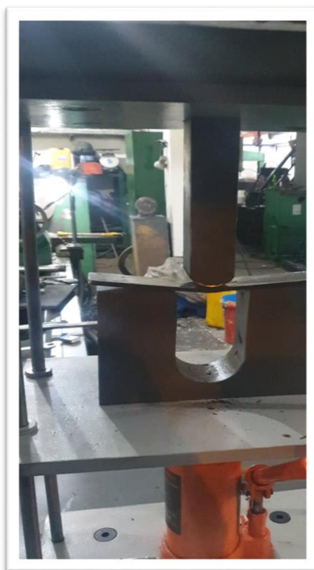
Anexo 14. Doblado de la probeta parte 2.
