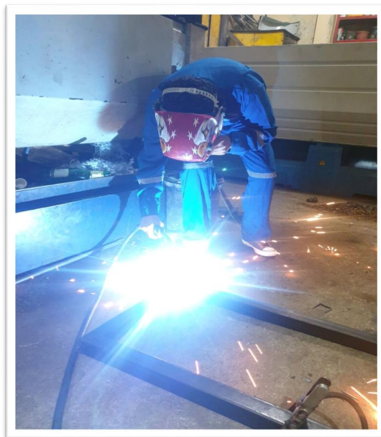
Anexo 2. Soldadura de los marcos de la estructura.
