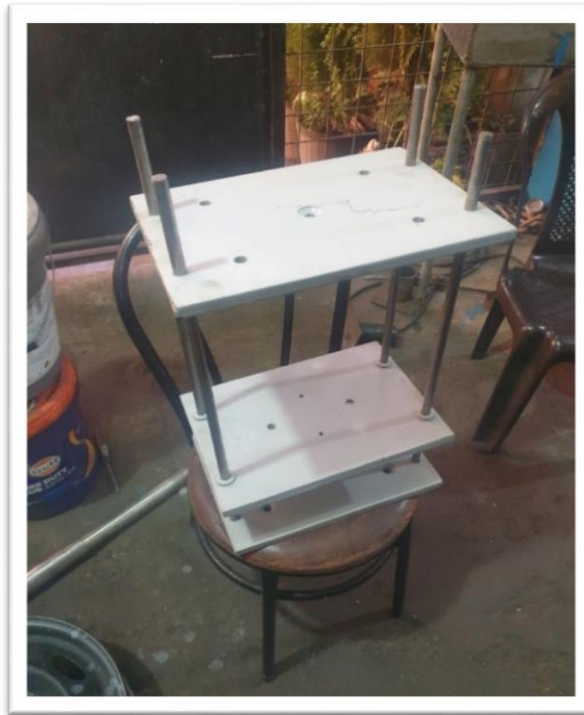
Ilustración 48. Armado del Mecanismo de soporte de la matriz.
