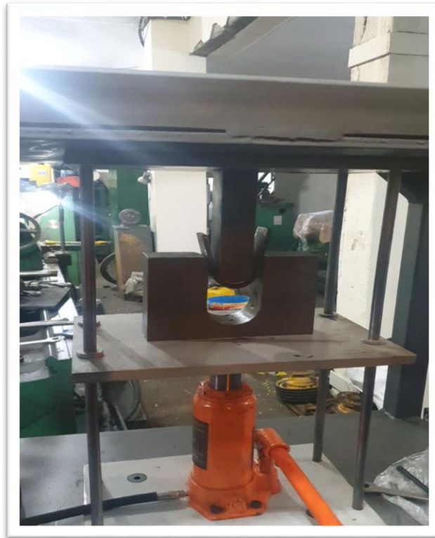
Ilustración 60. Ensayo de la probeta parte intermedia.
