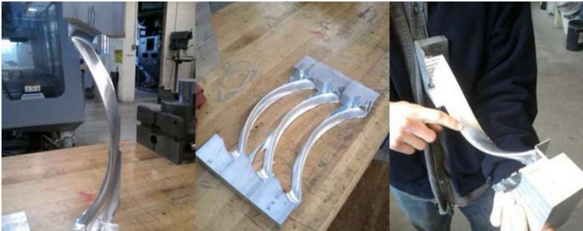
Ilustración 30. Imágenes de los álabes durante la fabricación.
