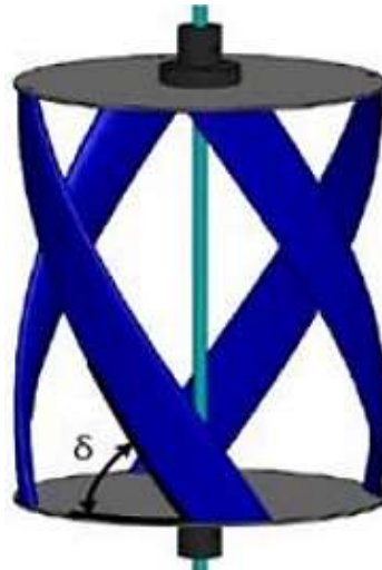
Ilustración 17. Ángulo de paso helicoidal \delta de la turbina helicoidal.
