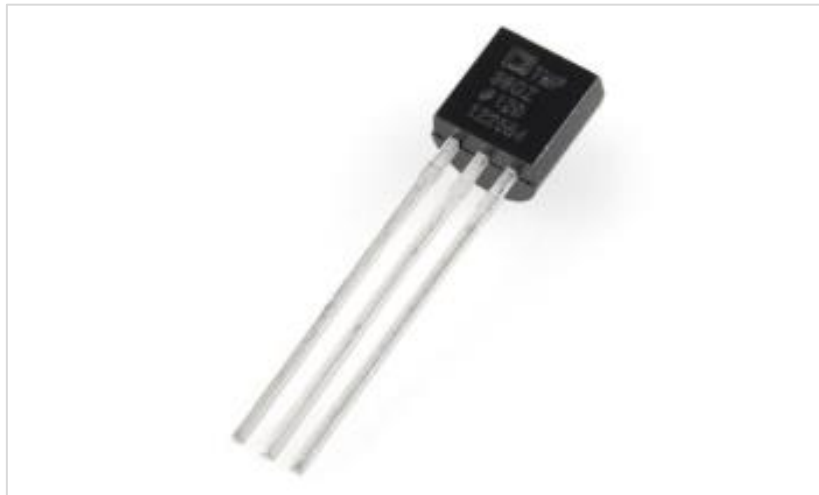
Ilustración 16 Sensor de temperatura para ambiente hidropónico.
