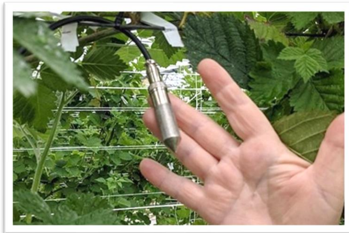
Ilustración 1 Termohigrómetro instalado entre las plantas para su monitoreo.
