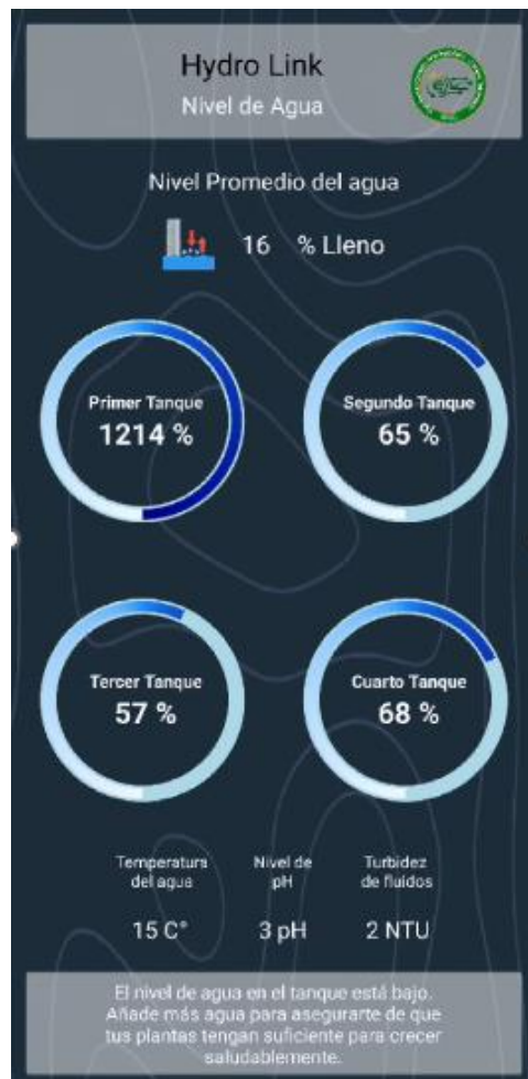
Ilustración 57 Interfaz del sensor proximidad que mide el nivel de agua de la App Hydro-Link.
