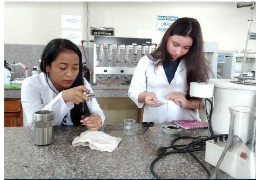
Ubicación de muestra en la bomba calorimétrica
