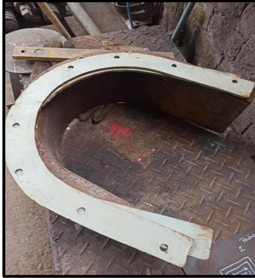
Anexo 1. Cortado, perforado y doblado del modulo
