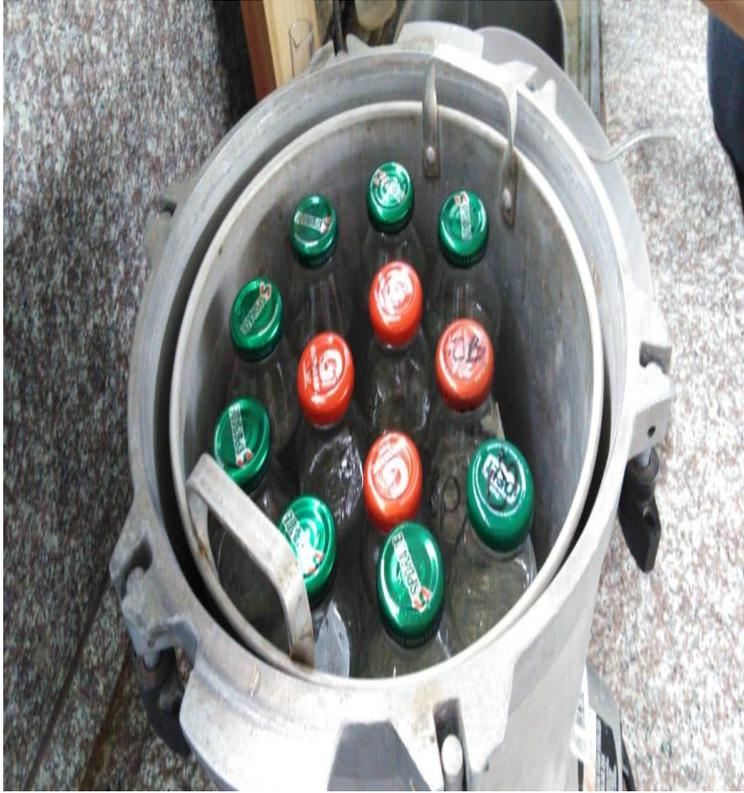
Foto N° 4: Envases listos después del esterilizado en el autoclave.
